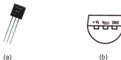
Gambar 4. (a) Bentuk fisik IC sensor suhu LM35, (b) Konfigurasi kaki LM35 kemasan plastik TO-92 (LM35CZ, LM35CAZ atau LM35DZ)
