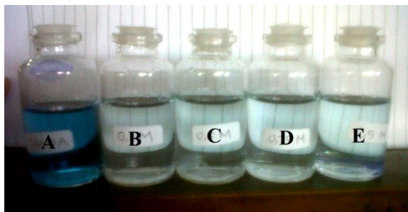
Gambar 5 Hasil pengujian fotokatalis selama 5 jam larutan methylene blue (A) kontrol, (B) 0,3M, (C) 0,5M, (D) 0,75M, (E) 0,9M.
