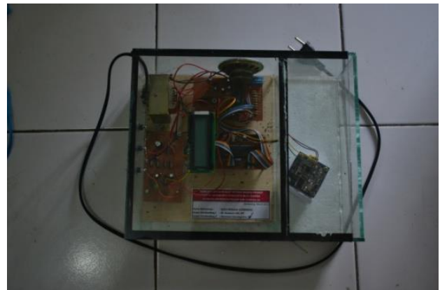
Gambar 4.4 Hasil Rancang Bangun Alat Deteksi Warna
