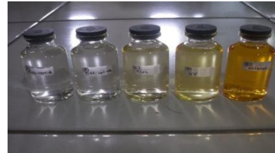
Gambar 7. Warna sampel hasil fotodegradasi selama 12 jam: (a) Lapisan tipis nanokomposit TiO 2 /CNT refluks, (b) Lapisan tipis nanokomposit TiO 2 /CNT non refluks, (c) Lapisan tipis TiO 2 (d) UV (e) kontrol
