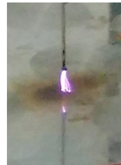
Gambar 7. Fenomena saat jarum suntik diberi tegangan DC HV yang diberi polarisasi positif
