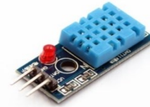
Gambar 1. Sensor suhu dan kelembaban DHT 11 [18]
