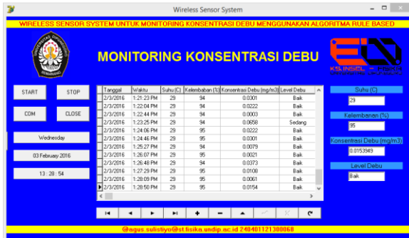
Gambar 9. Hasil sistem akuisisi pembacaan sensor
